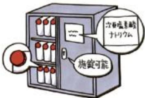
固形塩素剤で特に、次亜塩素酸カルシウムを主成分とする塩素剤の保管は揮散した塩素ガスが金属を激しく腐食するため、専用保管室で行うこと。学校プールで、プールはもう使用しないが、未使用の塩素剤が残ってしまった場合。その塩素剤の保管場所は機械室ではない別の場所（薬品保管庫など）で保管する。
