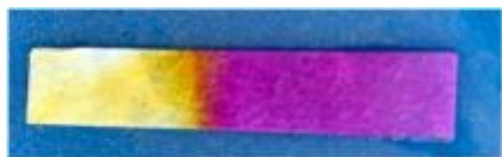
※0～100ppm用は、総残留塩素濃度を測定するため、次亜塩素酸水用として用いられる。
