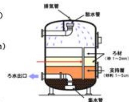
濁度成分がろ過器のろ過機構により捕集され除去される。
