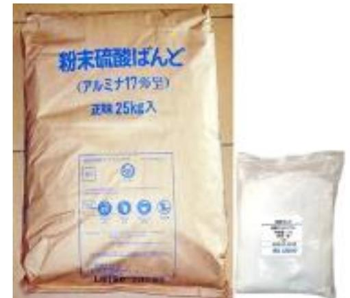
普通学校プールにおいて凝集剤には、硫酸バンド及びポリ塩化アルミニウムが用いられ、pH調整剤としてソーダ灰を使っているところが多い。
