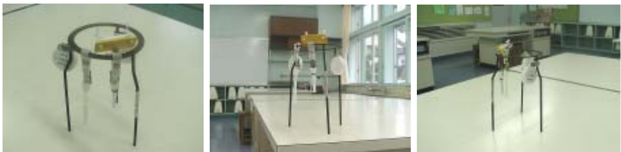
種々のパッシブサンプラー・測定バッジ・パッシブチューブのセット例
